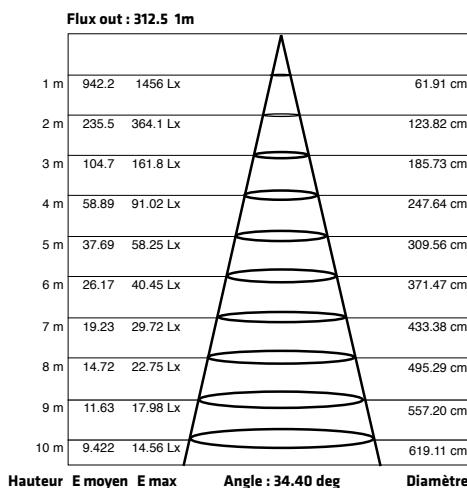
Note : Les courbes indiquent la zone éclairée et la moyenne d'éclairage lorsque le luminaire est à différentes distances.
