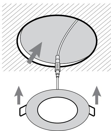
Bien que nos plafonniers DEL ultra-minces soient fonctionnels avec la plupart des dimmers et que ceux-ci affichent un maximum de 150 watts pour les appareils au DEL, il est fortement recommandé de ne pas dépasser 80% de cette capacité afin d'éviter le sautillement de l'éclairage lorsque le dimmer est à sa position la plus basse. Par exemple nous recommandons un maximum de 8 appareils de 6 pouces (total de 120 watts) ou un maximum de 13 appareils de 4 pouces (total de 117 watts).
